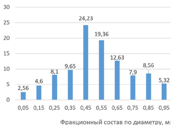
Рисунок 3. Фракционное распределение диаметра волокон марки M20-UTB 0,6 мкм
