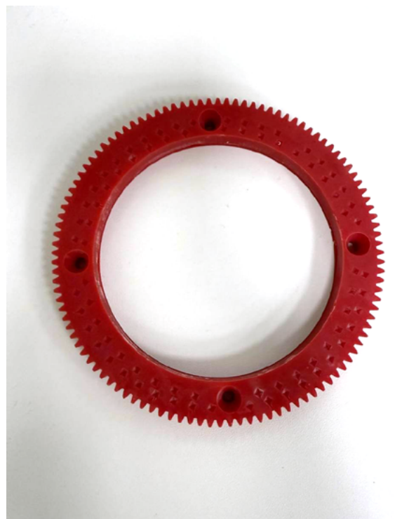
Рисунок 8. Зубчатые колёса, изготовленные с помощью стереолитографического 3D-принтера
