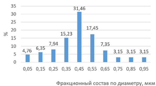
Рисунок 2. Фракционное распределение диаметра волокон марки ME-MTB 0,4 мкм
