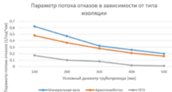
Рисунок 4. Сравнение параметра потока отказов для труб с разными типами тепловой изоляции
