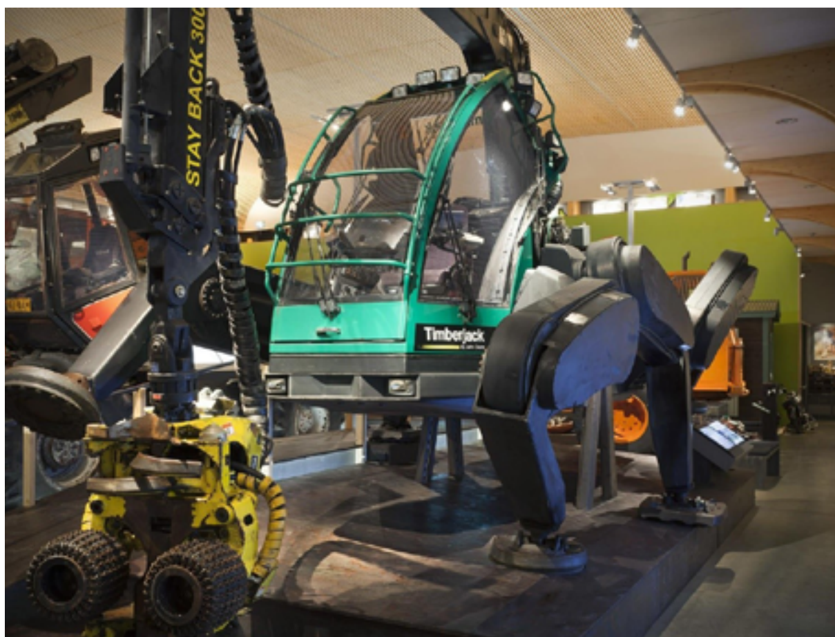
Рисунок 5. Экспериментальный харвестер Timberjack Figure 5. Timberjack experimental harvester
