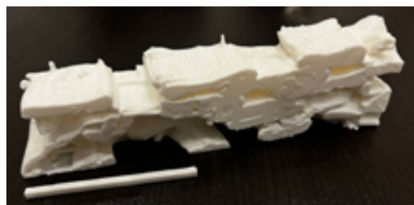
Рисунок 12. Готовая 3D-модель фрагмента микроструктуры покровного слоя гофрокартона
