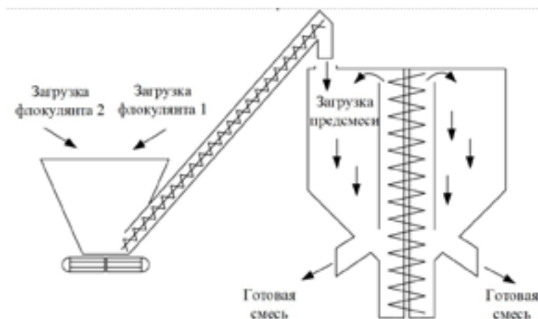
Рисунок 1. Функциональная схема дозирования и смешивания флокулянта
