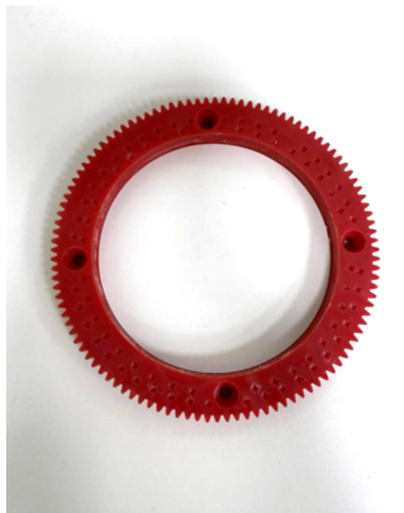
Рисунок 8. Зубчатые колёса, изготовленные с помощью стереолитографического 3D-принтера
