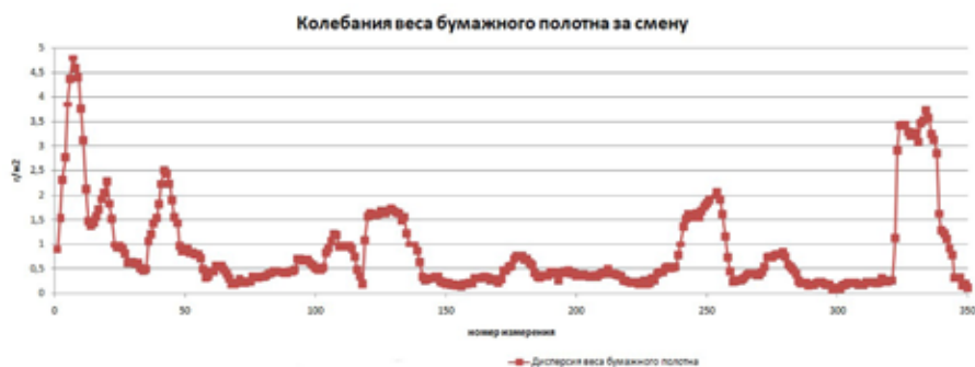
Рисунок 2. Статистический анализ колебаний массы бумажного полотна в установившемся режиме работы бумагоделательной машины Figure 2. Statistical analysis of paper web basis weight fluctuations in steady-state paper machine operation
