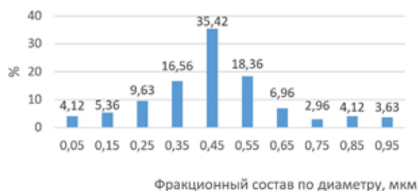
Рисунок 1. Фракционное распределение диаметра волокон марки М20-MTB 0,4 мкм
