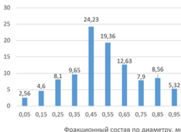
Рисунок 3. Фракционное распределение диаметра волокон марки М20-УТВ 0,6 мкм
